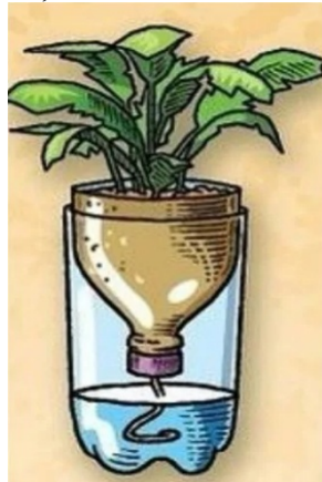
Рис.1 Простейшая гидропонная установка из подручных материалов.
